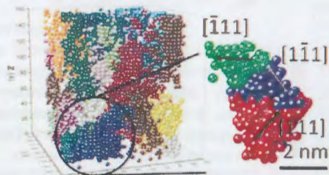
Рис. 5 — Корреляции между смещениями Pb. Кластеры атомов Pb, имеющие значения параметра локального смещения-выравнивания \alpha для первой координационной сферы Pb-Pb меньше 45^\circ , и трехмерная визуализация репрезентативного \alpha -PNR с составляющими атомами Pb, которые смещены в неэквивалентных направлениях \langle 111 \rangle , обозначенных разными цветами (справа)
